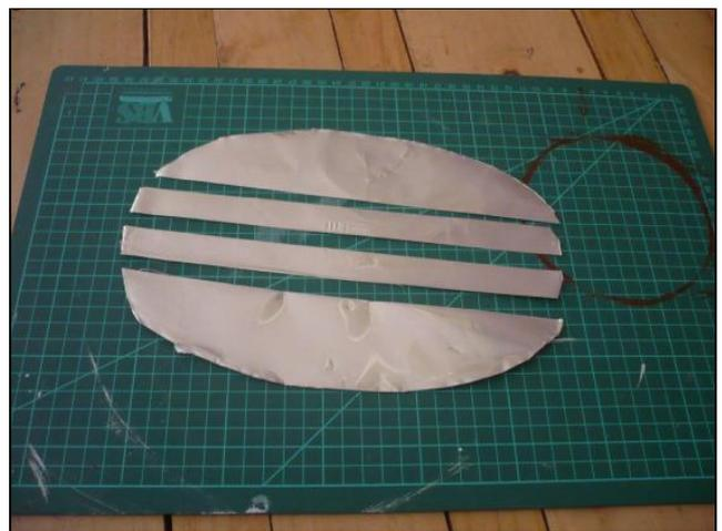
Dann zieht ihr mit der Kugelschreibermine einen Längsstrich über den gesamten Streifen in Höhe von ungefähr 5 mm und biegt diesen mit Hilfe des Lineals um. Dann hat der Ausstecher oben eine stumpfe Kante und man schneidet sich beim Ausstechen nicht.
