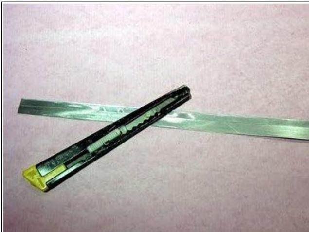
Den Alustreifen mit ungefähr 1,5 cm Überstand abschneiden und das doppelseitige Kleband einpassen, abschneiden und festdrücken.
